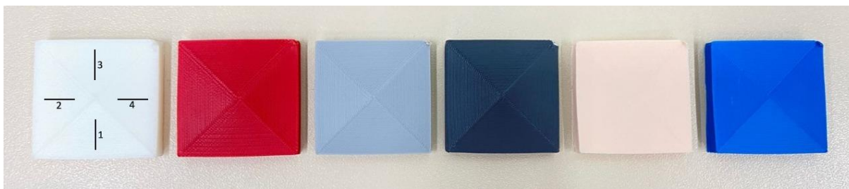
FIGURA 1. Corpos de prova fabricados nas cores natural, vermelho, cinza, preto, nude e azul. Fonte: Próprios Autores (2022).
