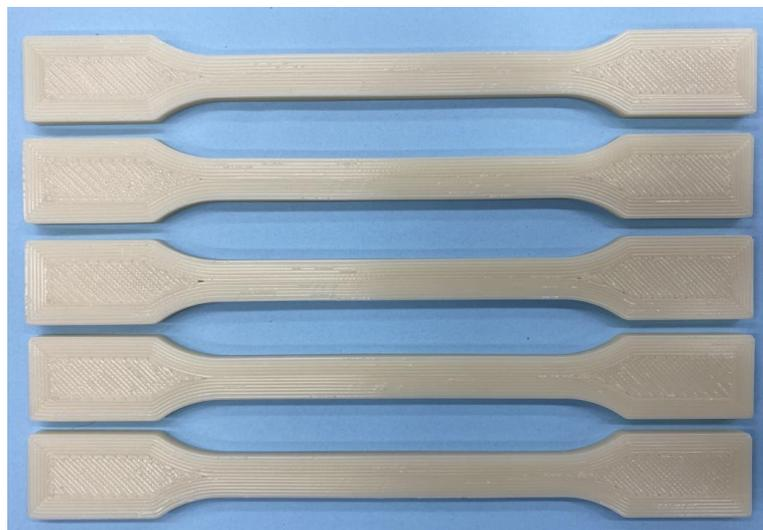
FIGURA 2. Lote de corpos de prova impresso em 3D para os ensaios mecânicos de tração.
