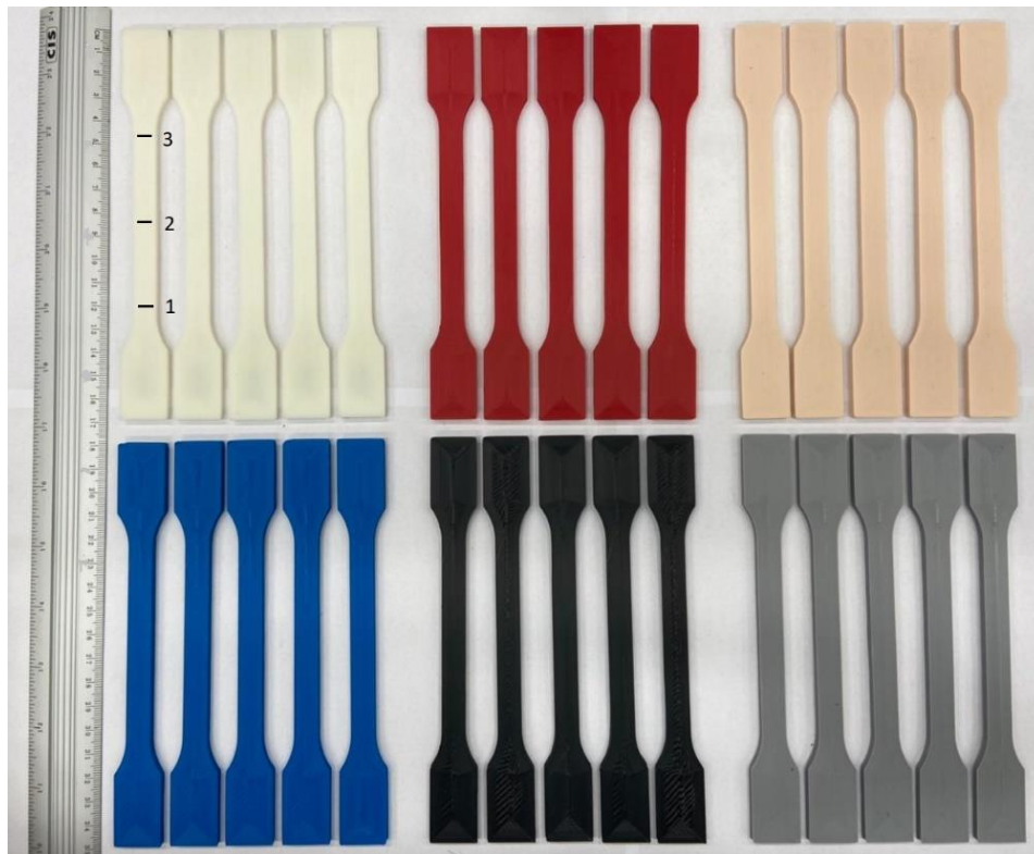
Figura 1: Corpos de prova produzidos nas cores natural, vermelho, nude, azul, preto e cinza.
