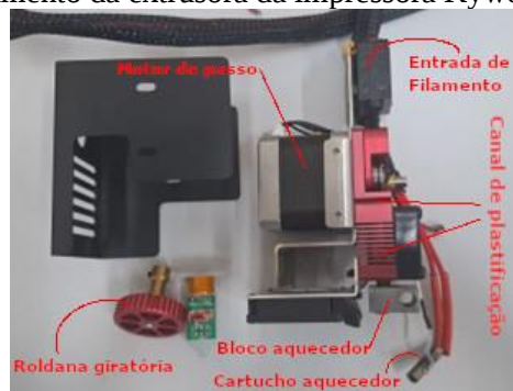
FIGURA 2. Reaproveitamento da extrusora da impressora Kywoo3D - Tycoon Max
