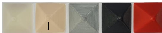
FIGURA 1. Corpos de prova produzidos nas cores natural, nude, cinza, preto e vermelho, da esquerda para a direita.
